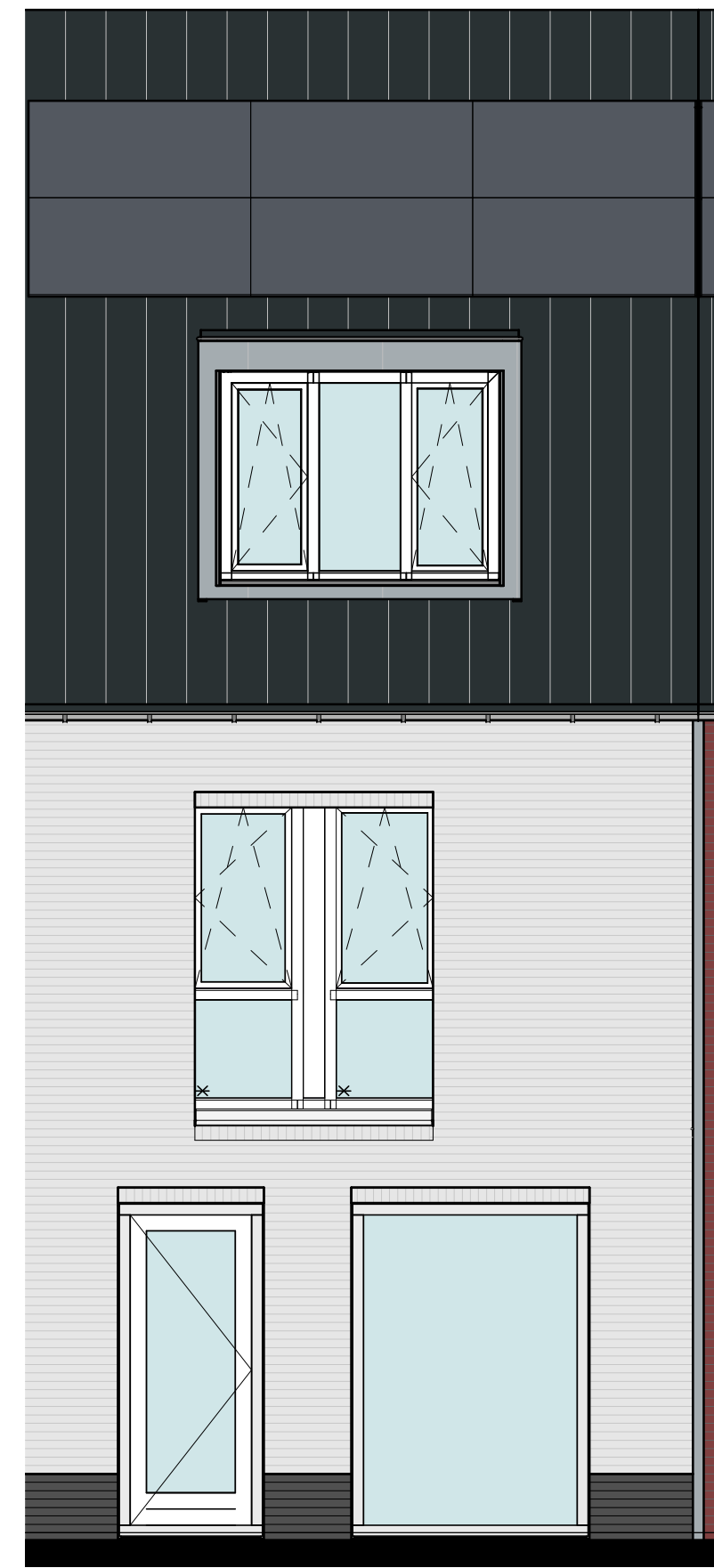
Optie 1.8.10 Dakkapel type L Aanzicht achtergevel
